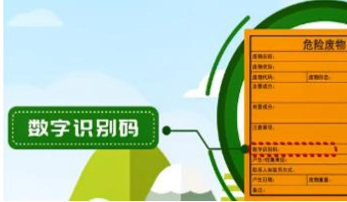
危险废物数字识别码 是设置在危险废物标签上的数字代码，利用“单位编码+废物代码+产生日期码+废物顺序码”的编码规则，可以准确定位至具体的危险废物。
